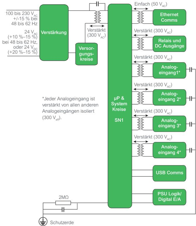
\*Jeder Analogeingang ist verstärkt von allen anderen Analogeingängen isoliert (300 V<sub>eff</sub>).
